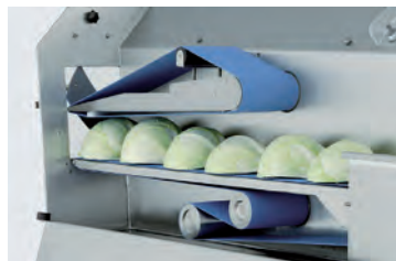
Благодаря правильной системе подачи продукт нужно лишь немного предварительно измельчать
