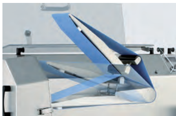
Настройка верхней части транспортёра в соответствии с особенностями продукта
